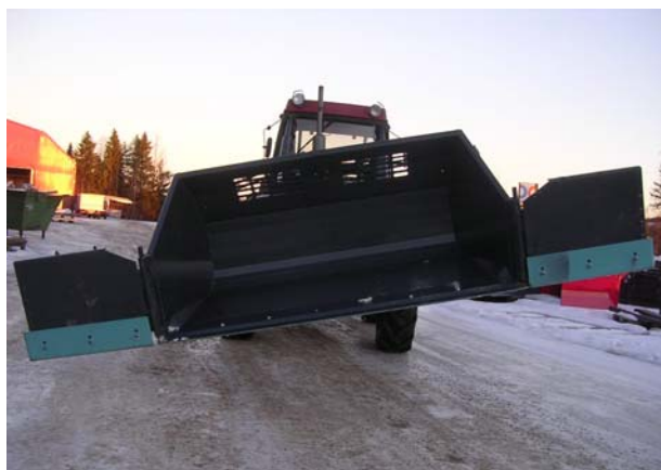
Multiskuffe 1,8 m 3 med hydr. hor.pendling (ekstrautstyr)
