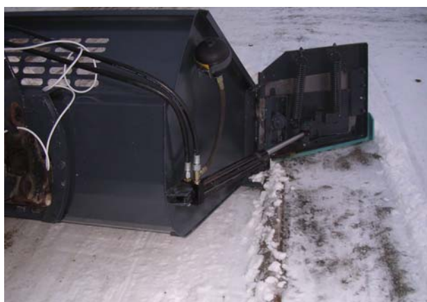
Høydesprang på ca. 150mm for fortauskant
