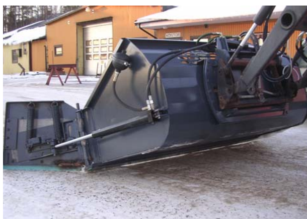
Følger underlaget og sliter skjærstålet jevnt
