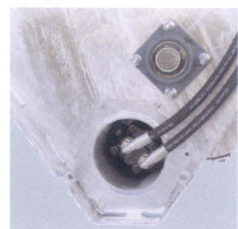
Drivmotoren for valsen sitter godt beskyttet, og direktdriften innebærer at det ikke trengs noen servicekrevende kjeder.
