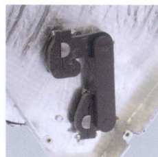
Kopling for drift av omrøreren. Ingen servicekrevende drivkjeder.
